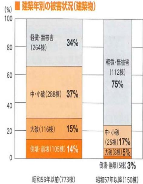
図-1.1 阪神・淡路大震災の被害と建築時期
